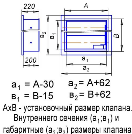
Рис.1. Установочные, габаритные и размеры внутреннего сечения клапана.
